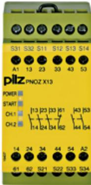
Sicherheitsschaltgerät (standalone), Eingänge: 1/2-kanalige Beschaltung mit/ohne Querschlusserkennung, Ausgänge: 5 S, 1 Ö, UB = 24 V DC, Breite: 45 mm, Schraubklemmen integriert, Überwachung von Not-Halt, Schutztüren.
