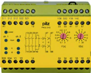
Sicherheitsschaltgerät (standalone), Eingänge: 1/2-kanalige Beschaltung mit/ohne Querschlusserkennung, Ausgänge: 3 S, 1 Ö, 2 Sz, automatischer/manueller Start, UB = 24 V DC, Breite: 112,5 mm, Schraubklemmen integriert, Überwachung von Not-Halt, Schutztüren, mit zwei unabhängig einstellbaren rückfallverzögerten Kontakten, Rückfallzeit 12 Stufen von 1 - 20 s/0,1 - 3 s.
