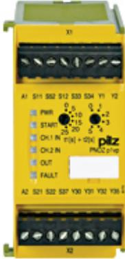
Sicherheitsschaltgerät (standalone), Eingang: 1/2-kanalige Beschaltung mit/ohne Querschlusserkennung, Ausgänge: 2 HL-Ausgänge, verzögerte Ansteuerung der Anschlüsse möglich, automatischer/überwachter Start, Breite: 45 mm, UB = 24 V DC, steckbare Klemmen in Schraubtechnik, Basisgerät PNOZpower modulares Sicherheitssystem, Verzögerung 0,3 - 30 s.
