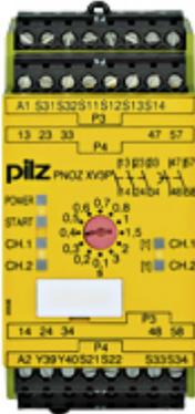
Sicherheitsschaltgerät (standalone), Eingänge: 1/2-kanalige Beschaltung mit/ohne Querschlusserkennung, Ausgänge: 3 S, 2 Sz, automatischer/überwachter Start, UB = 24 V DC, Breite: 45 mm, steckbare Schraubklemmen, Überwachung von Not-Halt, Schutztüren, Rückfallzeit 12 Stufen 0,1 - 3 s.
