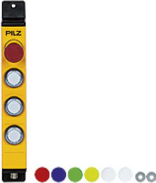
PITgatebox (Taster-Unit), vorkonfektioniertes Gehäuse mit Bedienelementen und Not-Halt, 40 mm Baubreite, Box mit Not-Halt (2 NC/ 1 NO), 2 beleuchteten Drucktastern (je 1 NO) und 1 unbeleuchteten Drucktaster (1 NO), Anschluss 12-pol. M12 Stecker, IP65, inkl. Farbkappen in den Farben GN, BU, RD, YE sowie transparent
