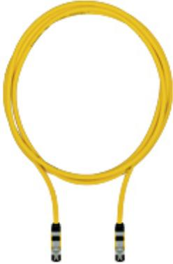
Netzwerkkabel, SafetyNET p, Cat5e, PUR, Gelb RAL1003, geschirmt, 4- polig, Stecker gerade RJ45 (IP20), auf Stecker gerade RJ45 (IP20), Kabellänge: 2 m
